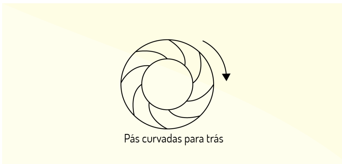
Figura 4.8 - Ventilador centrífugo de pás para trás
