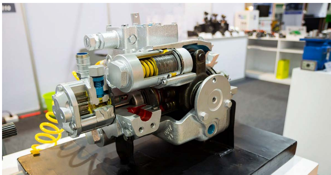
Figura 2.14 - Corte transversal em uma bomba hidráulica alternativa de pistão
