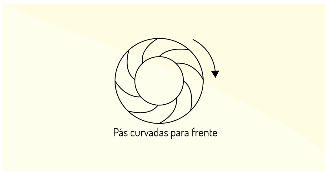
Figura 4.10 - Ventilador centrífugo de pás para frente
