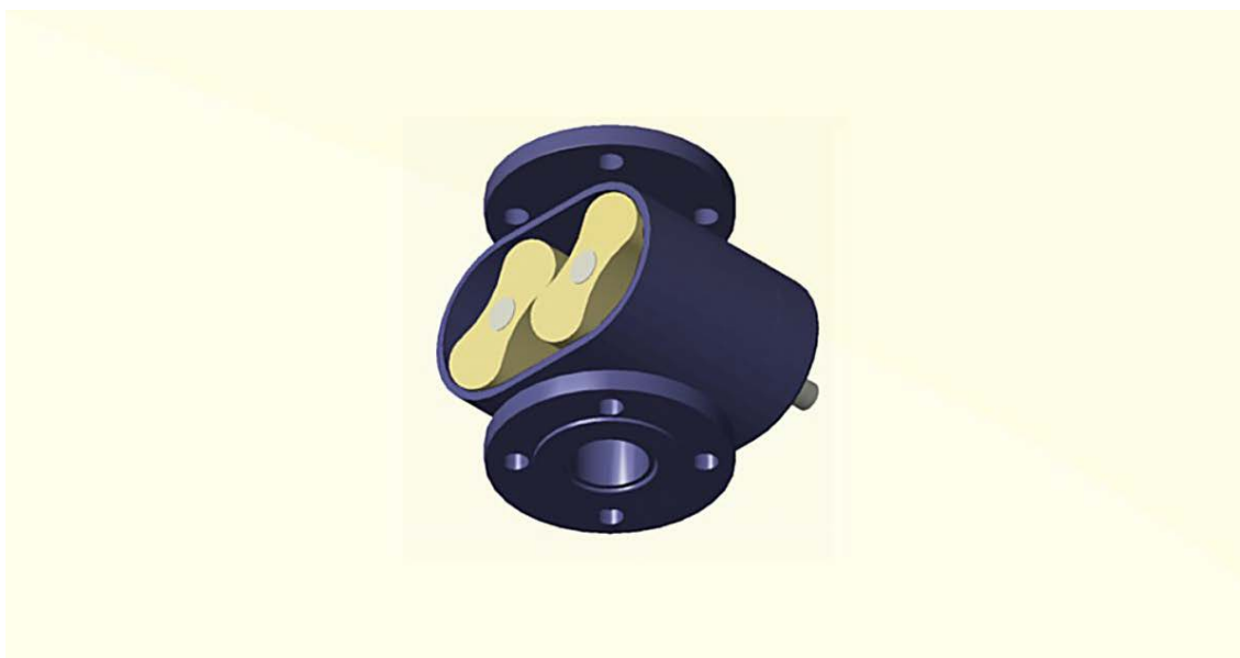
Figura 2.38 - Compressor rotativo de lóbulos
