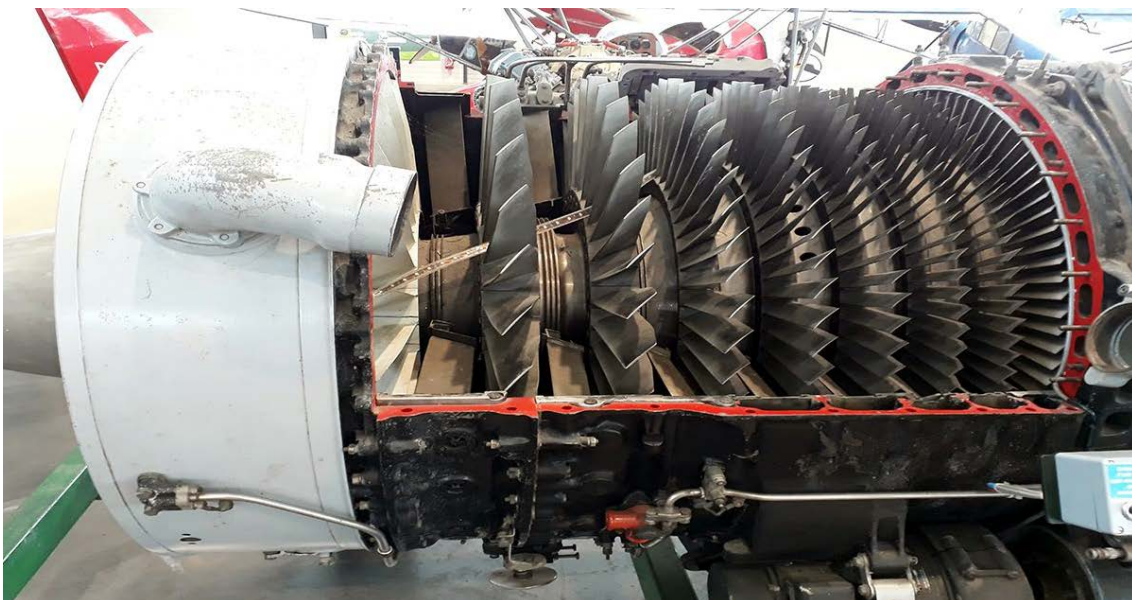
Figura 2.40 - Compressor centrífugo axial
