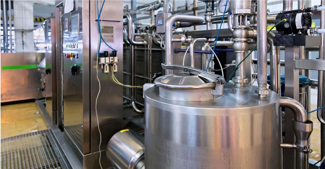
Figura 4.3 - Exemplo de equipamento utilizado na pasteurização rápida (HTST)
