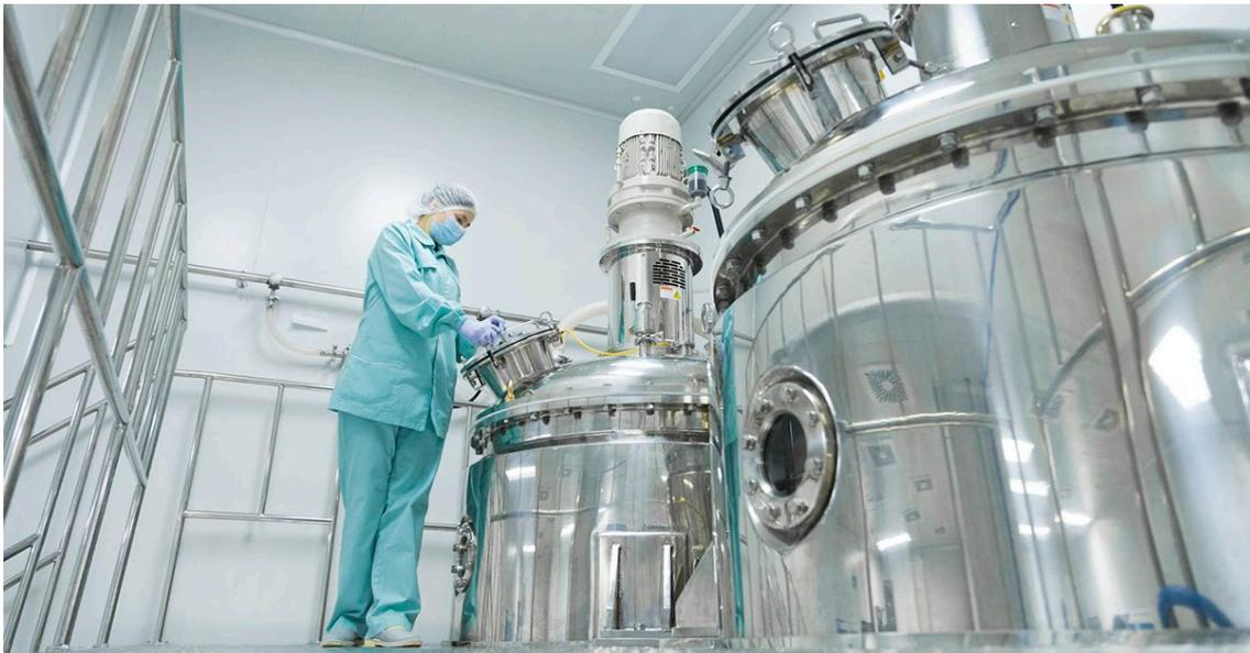
Figura 4.4 - Exemplo de autoclave utilizada para esterilização de alimentos
