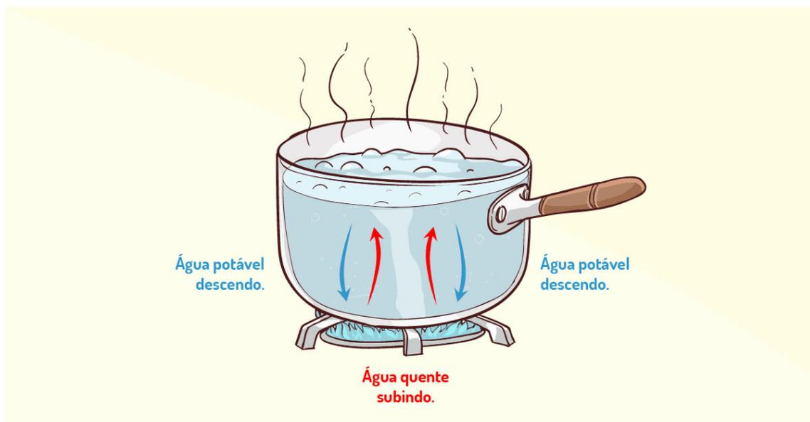
Figura 4.5 - Exemplo de transmissão de calor por convecção
