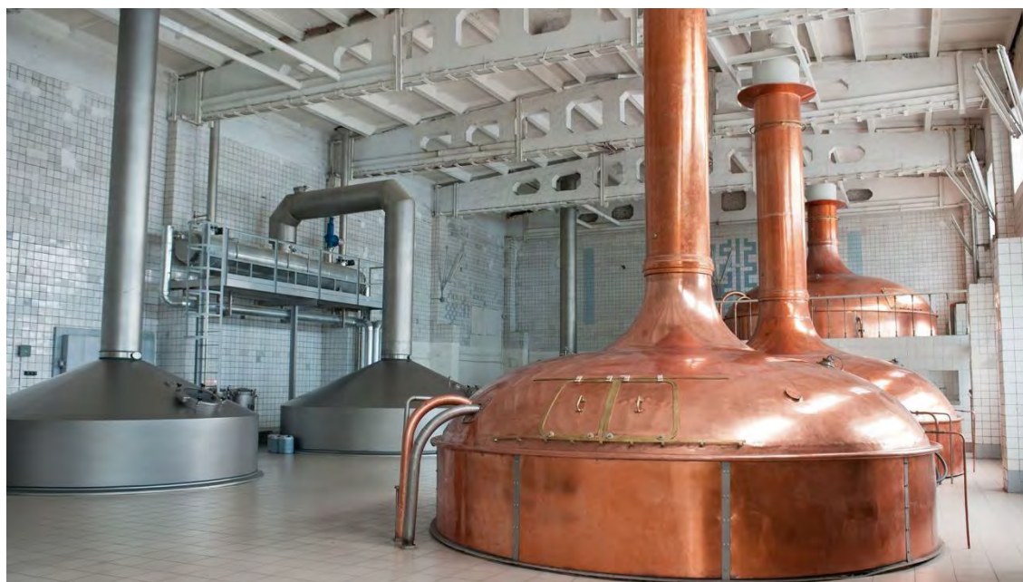
Figura 4.2 - Tanques de fermentação e pasteurização utilizados na produção de cervejas
