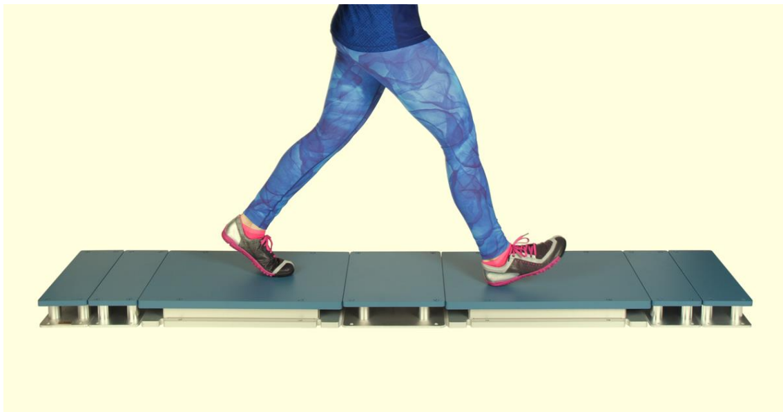
Figura 4.2 - Plataforma de força
