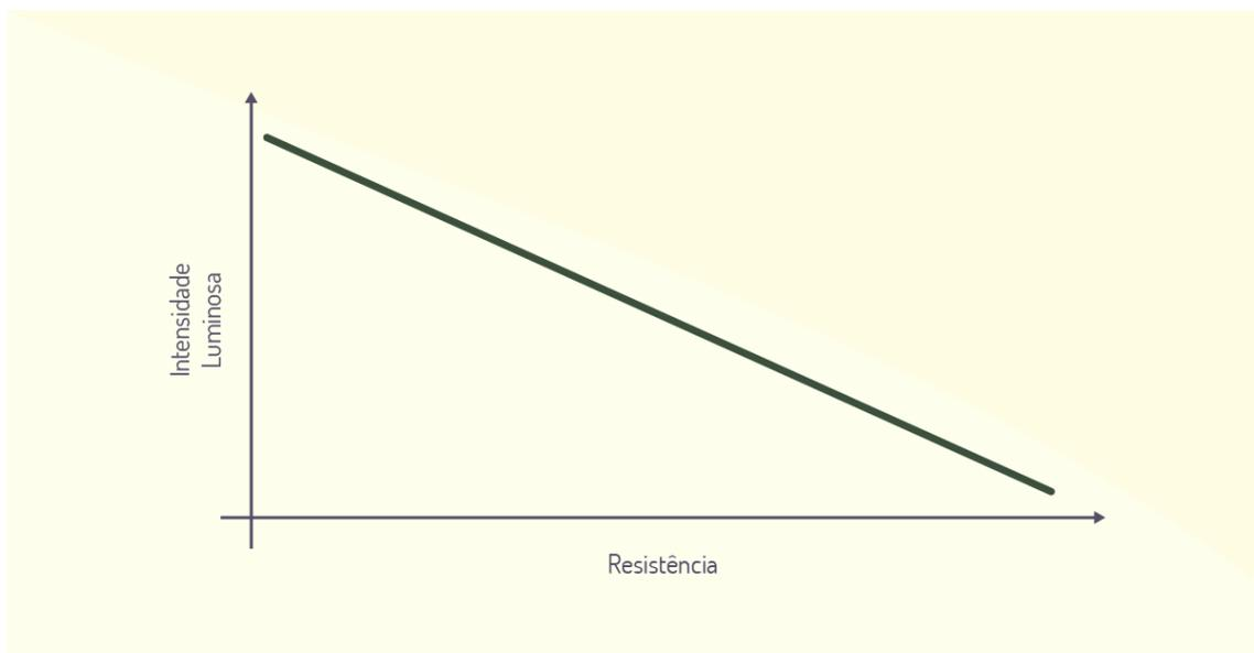
Figura 2.10 - Gráfico: Intensidade Luminosa vs Resistência
