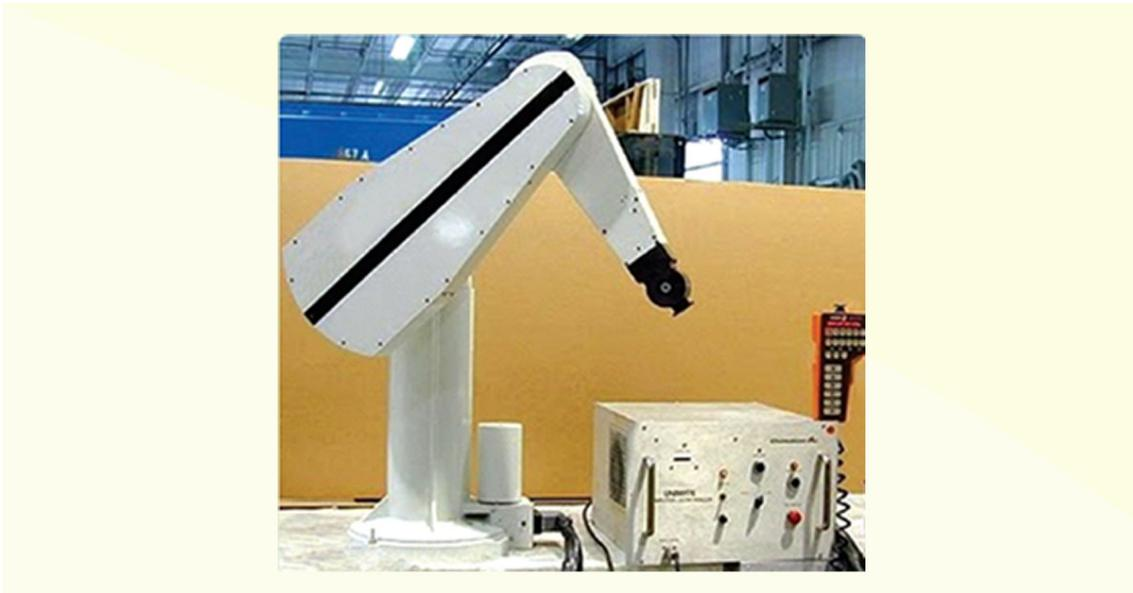
Figura 4.11 - Robô PUMA com seu controlador
