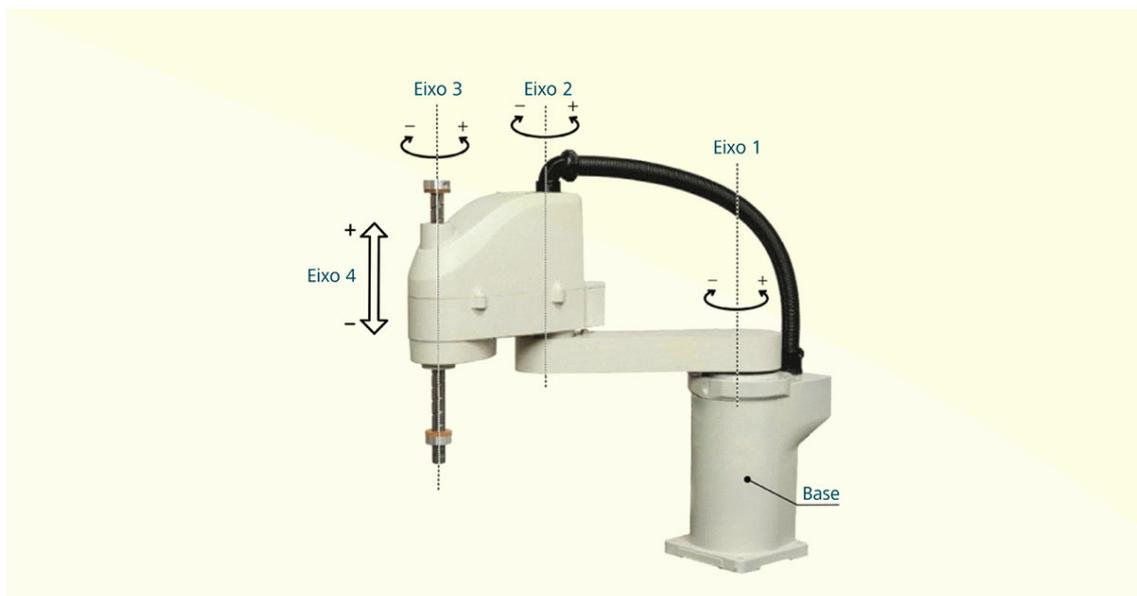
Figura 4.17 - Robô SCARA
