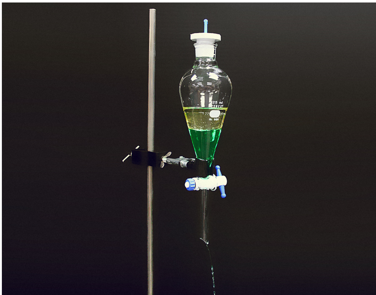
1FIGURA 5.10 - Funil de separação usado para a separação de uma mistura líquida heterogênea FONTE: Separatory...(2009).
